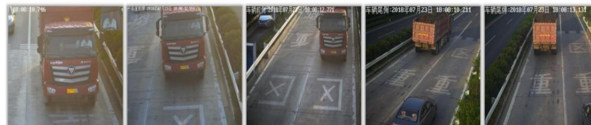
当车辆通过检测区时，车牌识别摄像机能够准确拍摄通过车辆的牌照特写图片，经过车牌识别软件识别出车辆牌照信息，然后通过称重控制器将照片和车牌信息与称重信息进行匹配。
