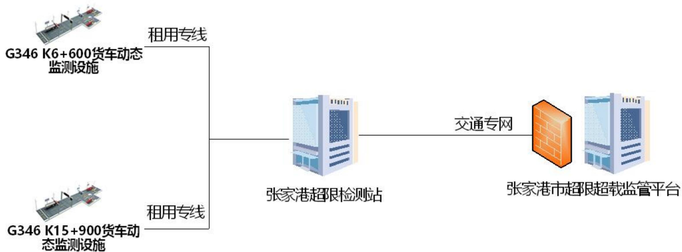
图 3-1 346 国道张家港货车动态监测设施网络架构图
